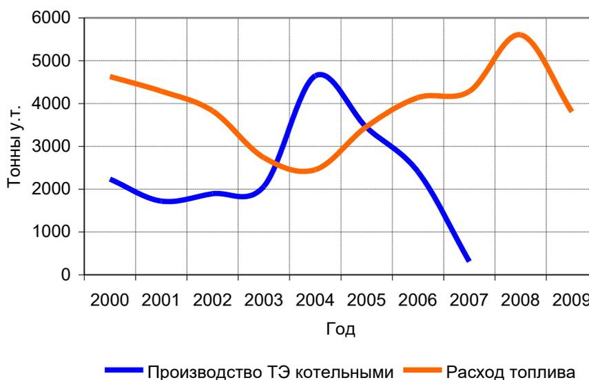
Рис. 3.8. Выработка тепла и расход топлива котельными Тегульдетского района, тонны у.т.
